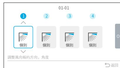
步驟6. 有設定風向板個別控制的場合，運轉操作畫面的風向設定會顯示「個別」。
